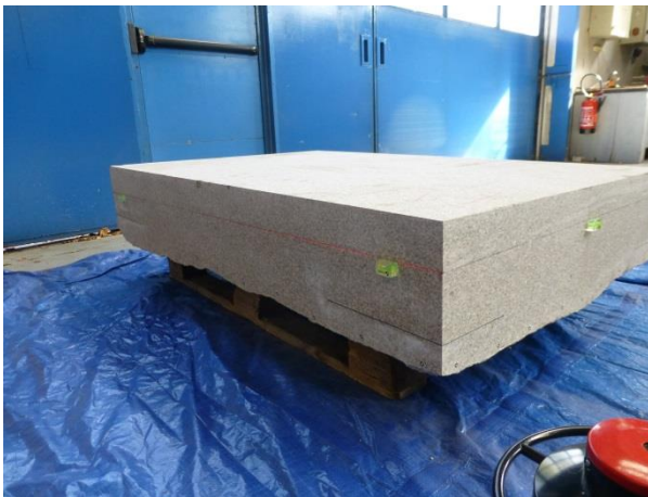
3 - Calage du bloc rocheux, retourné face rugueuse contre le sol, de sorte que le plan moyen de la surface rocheuse soit horizontal
