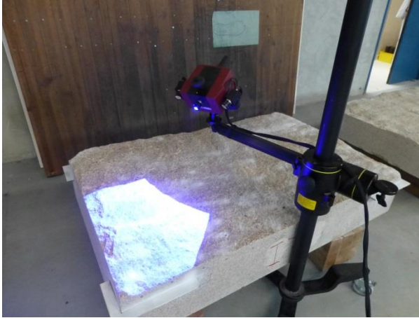
1 - Digitalisation de la surface rocheuse par la technique de stéréocorrélation d'images avec projection de lumière texturée
